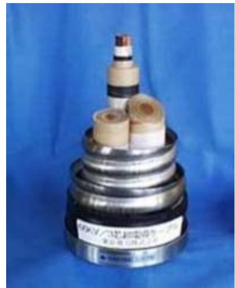
Figure 7. Essai sur le terrain d'un système de câble HTS triétagé 114 MVA, refroidi par un écoulement forcé d'azote liquide pressurisé (TEPCO, CRIEPI, SEI)
